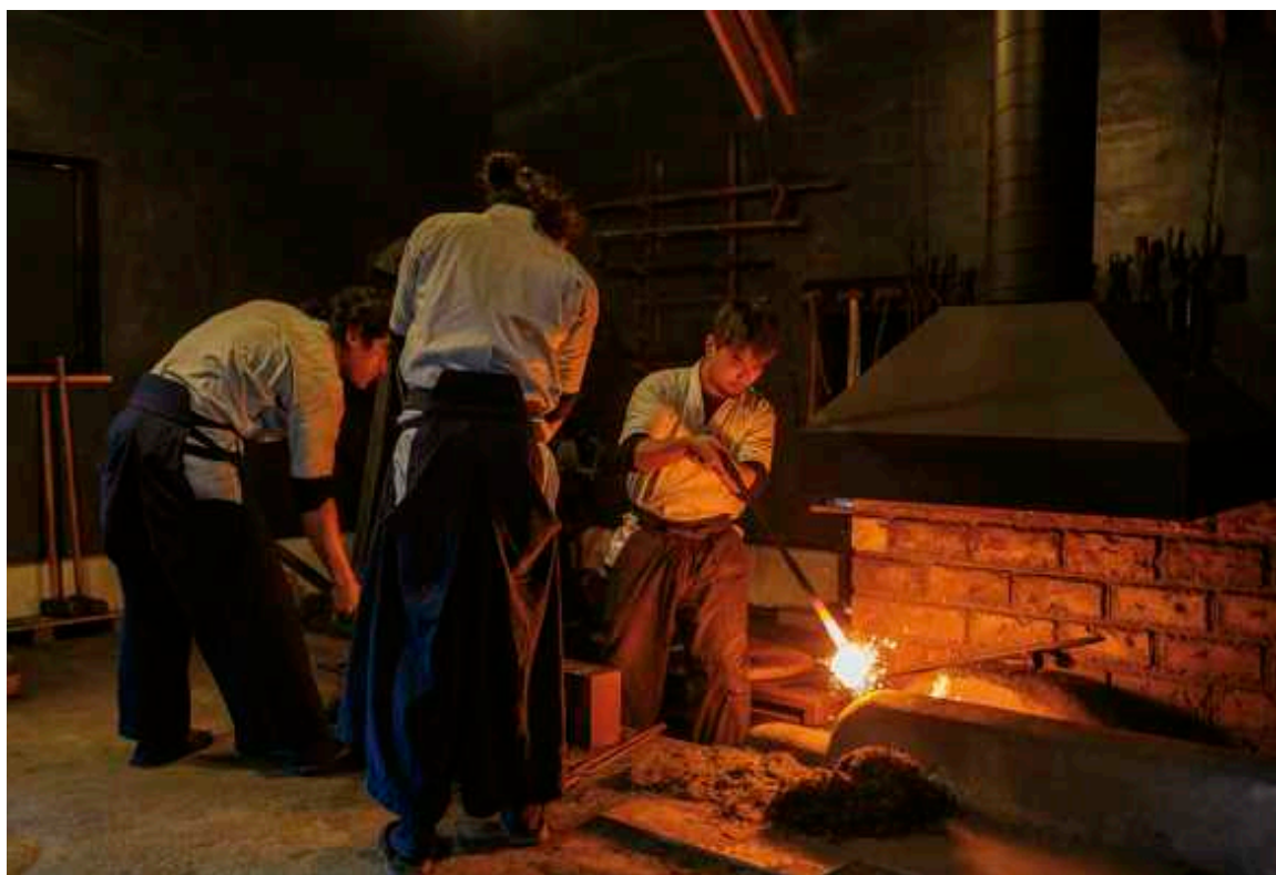
Tomoyuki Miyagi (l.), Tomoki Kuromoto (M.) und Kosuke Yamazoe (r.) hämmern, erhitzen und falten in einem aufwendigen Prozess ein Stück Stahl. Die Methode, tanren genannt, härtet das Metall.
